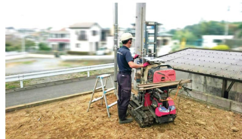
▲ 地盤調査機や微動探査システムを活用して、過剰な地盤改良工事の削減を目指している。
